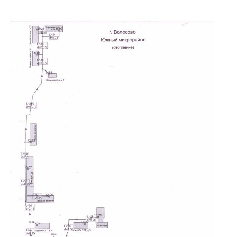
Таблица гидравлического расчета (отопление)
