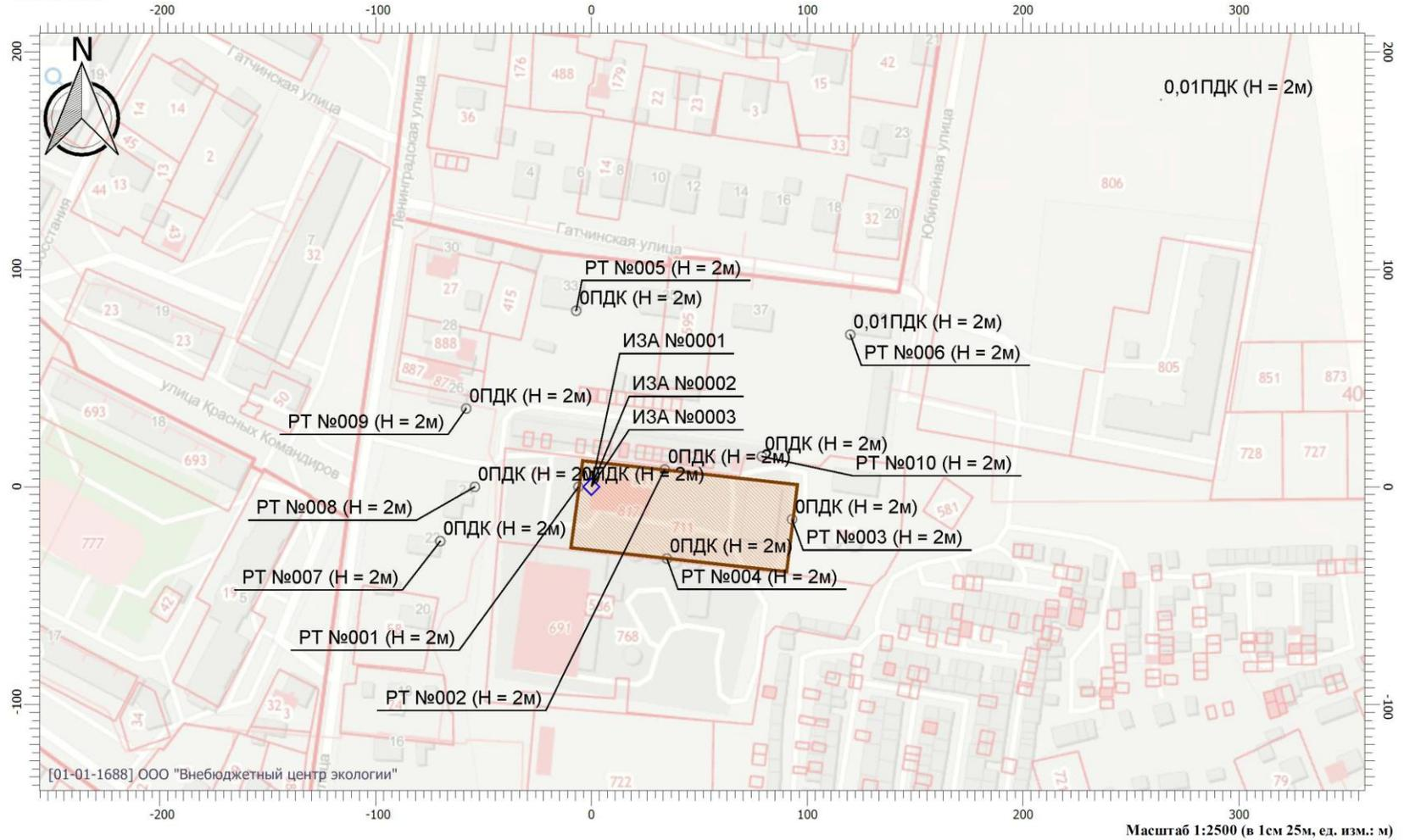
Рисунок 18.2.7. - Расчет рассеивания
